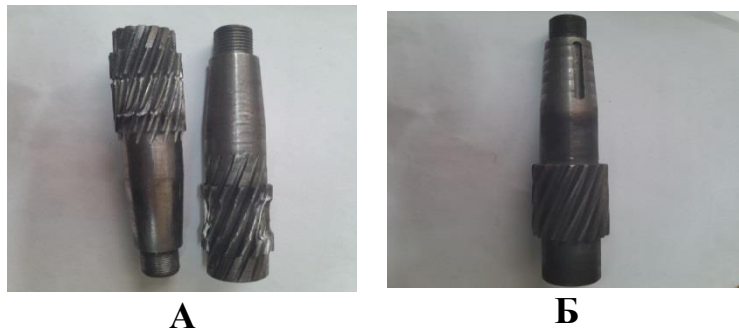
Рис.1. Вал-шестерня редуктора марки 1ЦУ-160. А-изношенный вал-шестерня из легированной стали ст40Х и Б-восстановленный из высоколегированной
