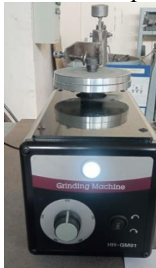
Рис3. Установка для определения износостойкости образцов.
