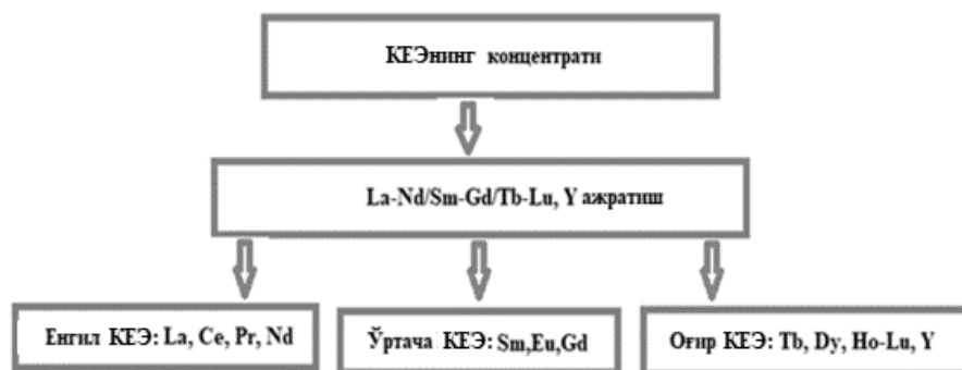
2-расм. КЕЭ гуруҳи концентратини ажратиш схемаси.
