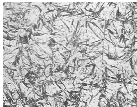
Рис.1. Микроструктура стали У12А после заковки от различных температур, \times 500
