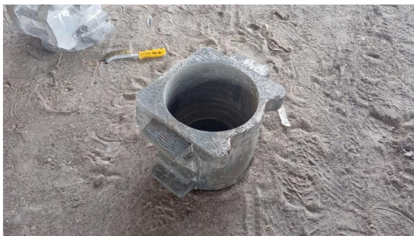
1-rasm. Buksa detalini quymasi.
