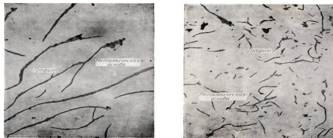
1-rasm. Cho‘yan tuzilishining mikroskop ostida ko‘rinishi.
